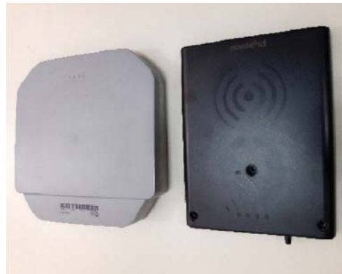
Figure 7.3 UHF RFID antennas.
