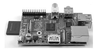
FIGURE 1-6: A RASPBERRY PI SINGLE-BOARD COMPUTER
