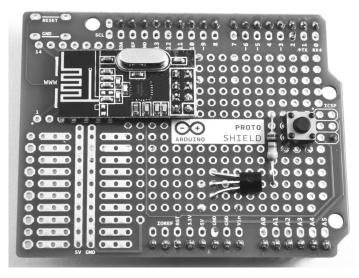
FIGURE 11-6: THE COMPONENTS ATTACHED TO THE PROTOSHIELD
