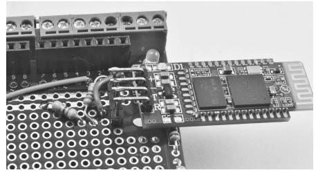
FIGURE 8-11: THE BLUETOOTH MODULE SOLDERED IN POSITION
