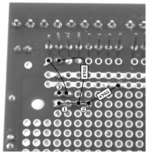
FIGURE 8-10: CONNECTING THE UNDERSIDE OF THE SCREWSHIELD
