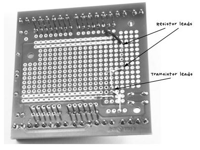
FIGURE 10-14: THE UNDERSIDE OF THE SCREWSHIELD
