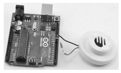
FIGURE 9-15: CONNECTING THE BUZZER TO THE ARDUINO
