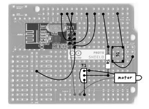
FIGURE 11-5: THE PROTOSHIELD LAYOUT, WHERE R1 IS THE RESISTOR, 51 IS THE SWITCH, T1 IS THE TRAN-SISTOR, AND THE DARK RECTANGLE AT THE TOP LEFT IS THE NRF24
