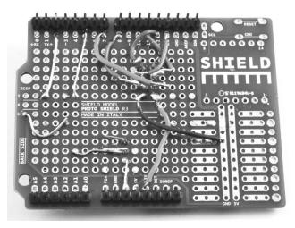
FIGURE 11-8: THE UNDERSIDE OF THE PROTOSHIELD
