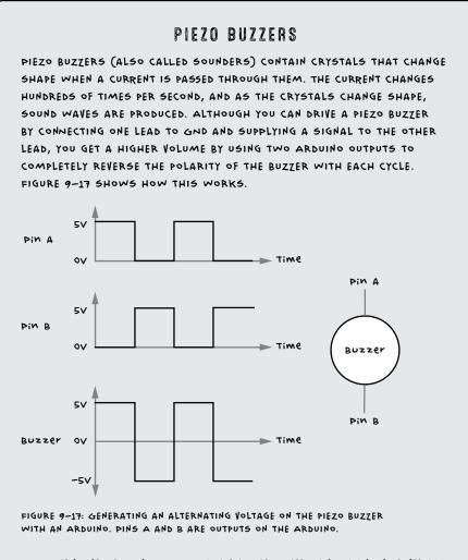
WHEN ONE ARDUINO OUTPUT IS HIGH, THE OTHER IS LOW AND VICE VERSA. THIS COMPLETE REVERSAL OF THE POLARITY ACROSS THE PIEZO BUZZER EFFEC-TIVELY ALLOWS A 10V PEAK SWING OF VOLTAGE ACROSS THE BUZZER RATHER THAN THE 5V OBTAINABLE FROM JUST SWITCHING ONE PIN.
