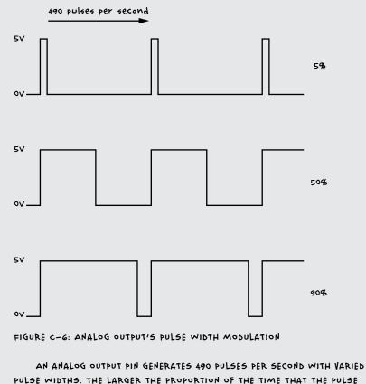
PULSE WIDTHS. THE LARGER THE PROPORTION OF THE TIME THAT THE PULSE STAYS HIGH, THE GREATER THE POWER DELIVERED TO THE OUTPUT, AND HENCE THE BRIGHTER THE LED OR FASTER THE MOTOR.
