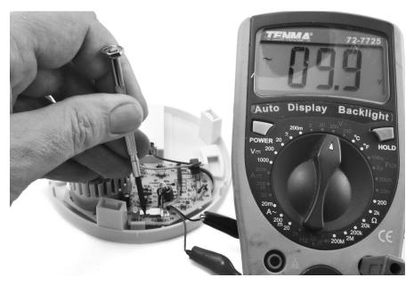
FIGURE 7-6: IDENTIFYING THE SMOKE ALARM BUZZER WIRES
