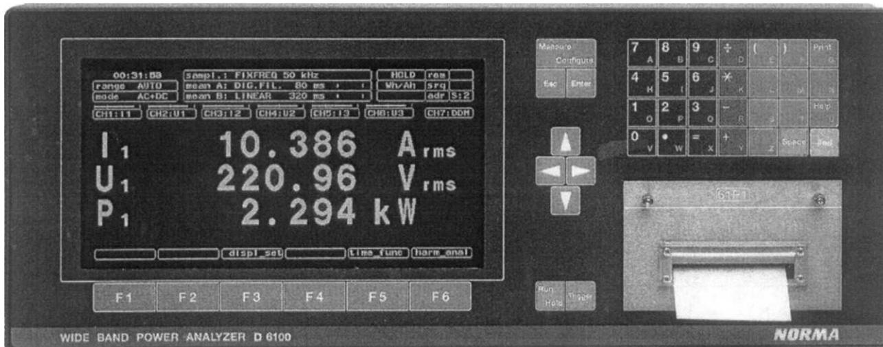
Fig. 2.32 Electronic wattmeter (Norma).
