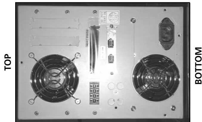
Figure 4.3 New Fan Grilles
