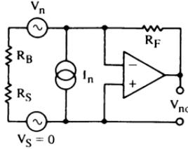
$$V_{ni} = V_{no}/A_v$$
