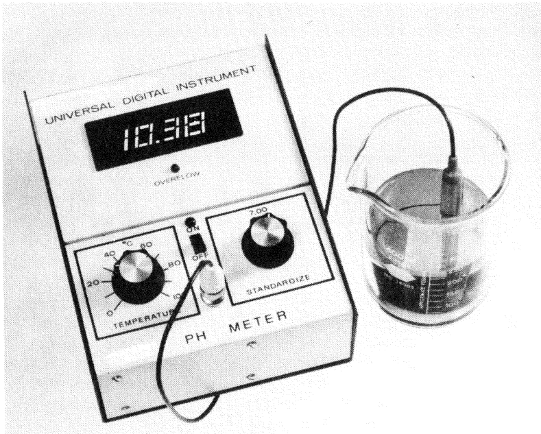
Fig. 7-10. Digital pH meter using a 3130 op amp.
