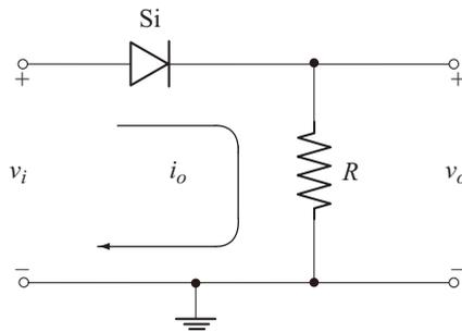
Fig. 1.18 Half-wave rectifier
