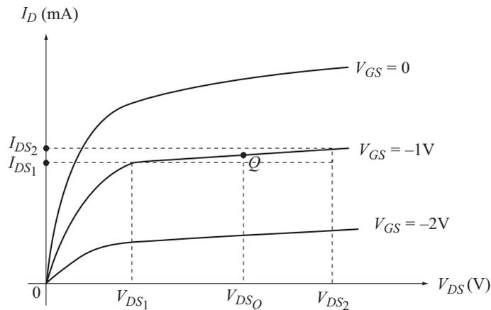
$$r_d = \left. \frac{V_{DS2} - V_{DS1}}{I_{DS2} - I_{DS1}} \right|_{V_{GS}=-1V}$$
