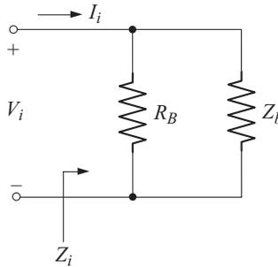
Fig. 3.46 Determining  $Z_i$
