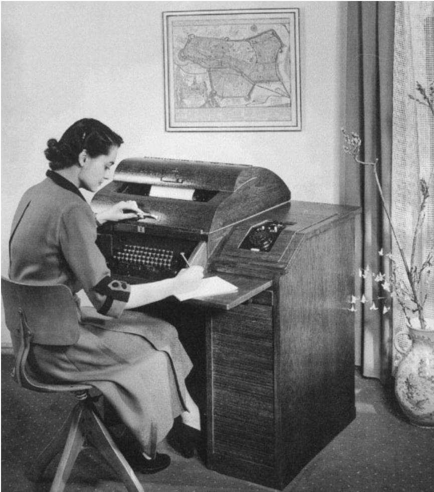
Figure 19.3 Siemens teleprinter, 1936. (© Siemens-Archiv, Munich.)
