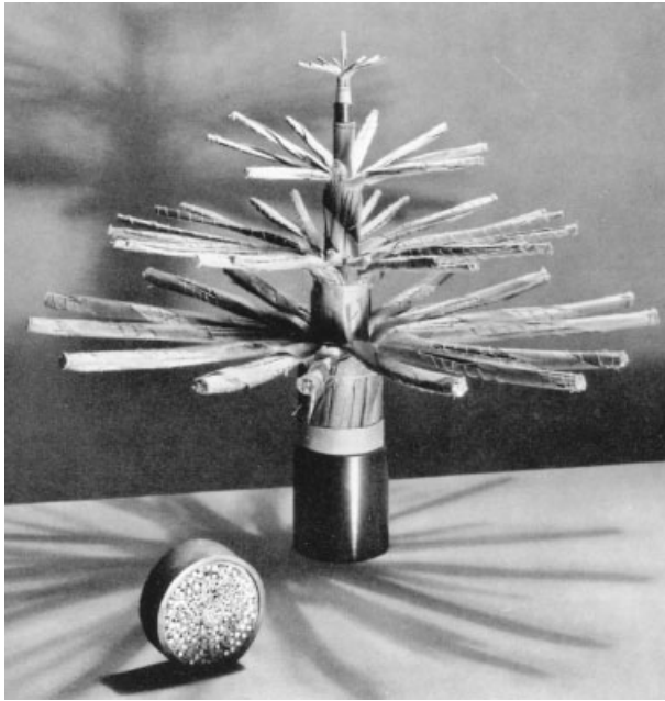
Figure 20.7 The 142-pair Rheinland cable. (© Siemens-Archiv, Munich.)
