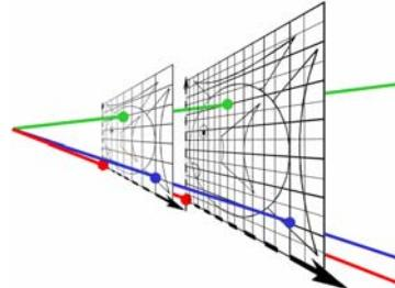
$$\begin{pmatrix} x' \\ y' \\ z' \\ 1 \end{pmatrix} = \begin{pmatrix} a & b & c & d \\ e & f & g & h \\ i & j & k & l \\ 0 & 0 & 0 & 1 \end{pmatrix} \begin{pmatrix} x \\ y \\ z \\ 1 \end{pmatrix}$$
